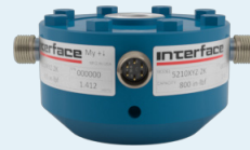
5200 XYZ 力/扭矩复合传感器 力: 1,000 至 5 万磅力 力矩: 400 至 2 万磅力英寸 力: 4.45 至 222 千牛 力矩: 45.2 至 2,260 牛米 F_z, M_x, M_y
